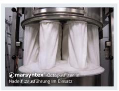
marsyntex°-Filter für Wirbelschichttrockner können in verschiedenen Größen und mit bis zu 98 Schläuchen produziert werden. Des Weiteren bieten wir diese in einem antistatischen Gewebe oder Nadelfilz mit verschiedenen Abscheideleistungen und unterschiedlichen Oberflächengüten an.
