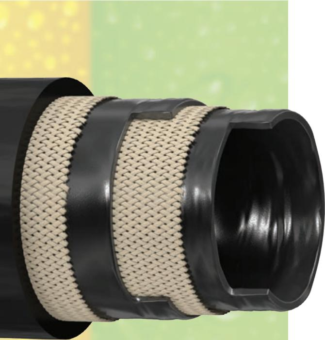
Der **marsoflex**<sup>®</sup>-Vielzweckschlauch Typ 80 ist ein Universal-Druckschlauch für viele Anwendungen mit hoher Sicherheitsanforderung. Der Schlauchtyp ist geeignet zum Fördern von Luft, Wasser, Öl, Fetten, Benzin, Stickstoff sowie diversen Chemikalien.
