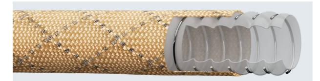
Das @marsoflex\* B3-Geflecht wird als Druckträger für PTFE Schlauchleitungen eingesetzt. Das Geflecht ist aus einem Polymer, welches für den Einsatz als Hochleistungsfaser entwickelt wurde und sich durch eine hohe Formstabilität und Chemikalienbeständigkeit auszeichnet. Durch eingeflochtene, sich kreuzende Edelstahllitzen (4-8 Litzen aus 1.4404) wird eine elektrische Leitfähigkeit <10² erreicht.
